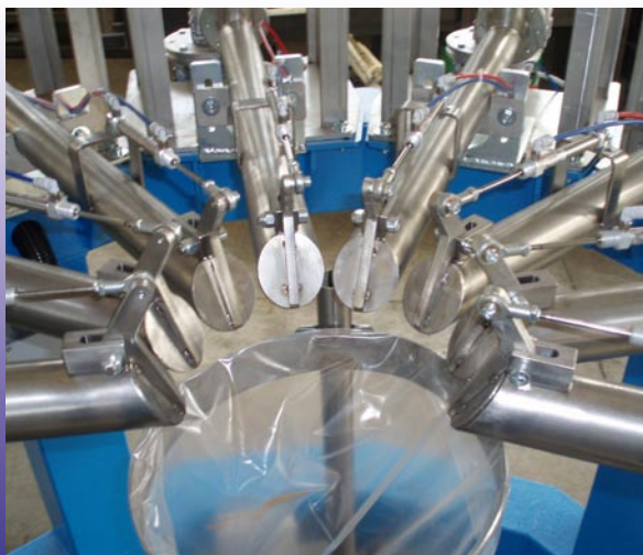
IMPIANTO DI DOSAGGIO COLORANTE IN GRANULO E POLVERI (PARTICOLARE)
